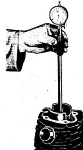
61 M Zylinder mit Innenfeinmeßgerät ausmessen
