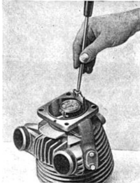
Bild 63. Einführen der Meßuhr in die Zylinderbohrung (Achtung, Schlitten nicht verkanten und Fühl- und Führungstift nicht in Steuerschlitze schnappen lassen!)
