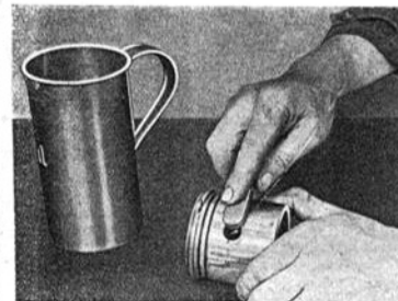
Bild 64. Nacharbeiten von Freistellen am Kolbenschaft mittels ölbefeuchtetem Korundstein
