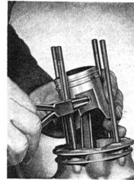
Bild 28. Entfernen der Kolbenbolzen-Siche-rungen mit Seegerzange Nr. 0997
