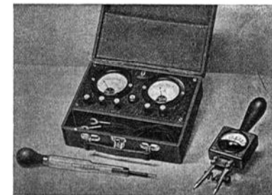
Bild 226. Prüfkoffer Nr. 01000, Säureheber mit Aräometer sowie Batterie-Zellenprüfer
