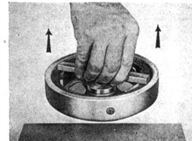
Bild 219. Die Prüfung der Magnetstärke, so wie im Bild gezeigt (anheben der Scheibe mittels über die Magnetpole gelegten Eisensüßes), ist nicht einwandfrei. Die Prüfung muß, wie im Text angegeben, durch Spannungsmessung erfolgen
