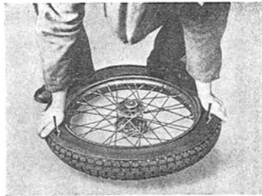
Bild 197. Durch Weitergreifen an beiden Seiten Deckenrand über Felgenreand bringen
