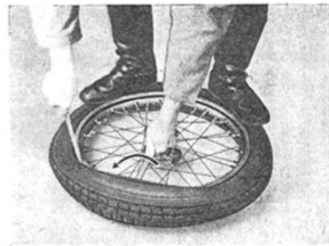
Bild 198. Hereinheben des letzten Stückes Deckenrand in die Felge. Gegenüberliegende Seite der Decke gut in das Tiefbett drücken
