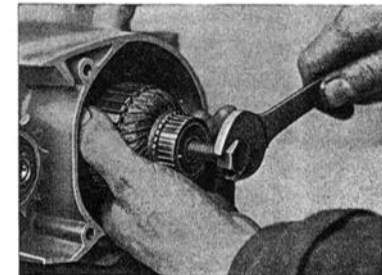
Bild 209. Abdrücken des Ankers RT 125 mittels Abdruckschraube Nr. 0100027
