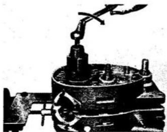
Abb. 35 Rechte Gehäusehälfte abziehen
