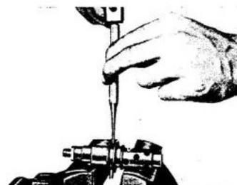
Abb. 38 Spannstift aus dem Ziehkeil und der Schaltmuffe ausschlagen
