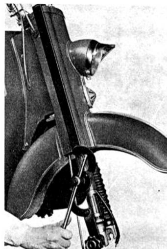
11 V Einbau des Gleitrohres mit Vorrichtung (0301-72200-00.2) VI/57/563
