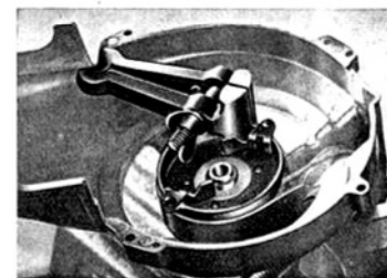
51 G Federkernnabe mit Feilkloben festgespannt VI/55/666
