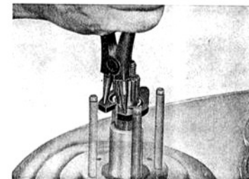
17 G Sprengling von Getriebewelle abnehmen VI/55/570
