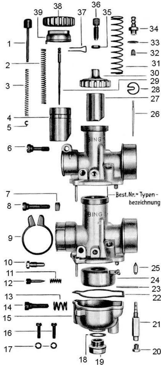
(38) 716480 Deckelverschraubung (für Vergaser 1/20/... bis 1/22/...)
